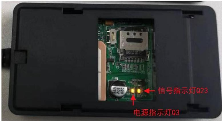
电源指示灯状态 **黄灯-Q3** 常亮 表示 供电正常（外电或备电）
